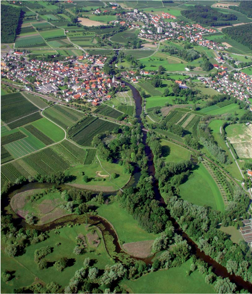
Abb. 1.10: Unterlauf der Schussen mit Eriskirch. Durch die Schussenbegradigung wurden die alten Mäander vom Hauptgerinne abgeschnitten. (Foto: Ortlepp)
